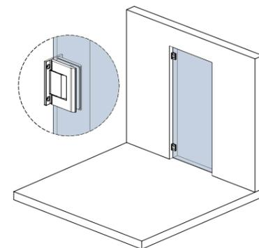
Segnare i 4 fori a muro e fissare mediante l'utilizzo di tasselli appositi.
