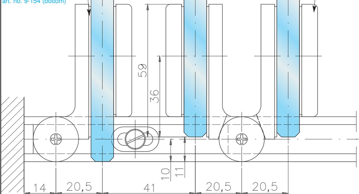
Horizontalschnitt 3 flg. Anlage Typ 3LE
